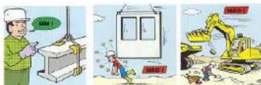
Não se deve permanecer no raio de acção das máquinas de elevação.
