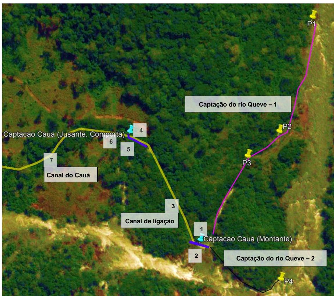
Figura 4 – Implantação das principais obras da captação do Cauá
