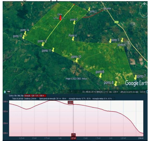
**Figura 4:** Sentido Norte-sul no limite Este, ao centro deste perímetro, em 264 m há uma variação entre 1208 m e 1346 m, com declive média de 6,1%. Exigirá aplicação de medidas anti erosivas a 1250 m da parcela.
