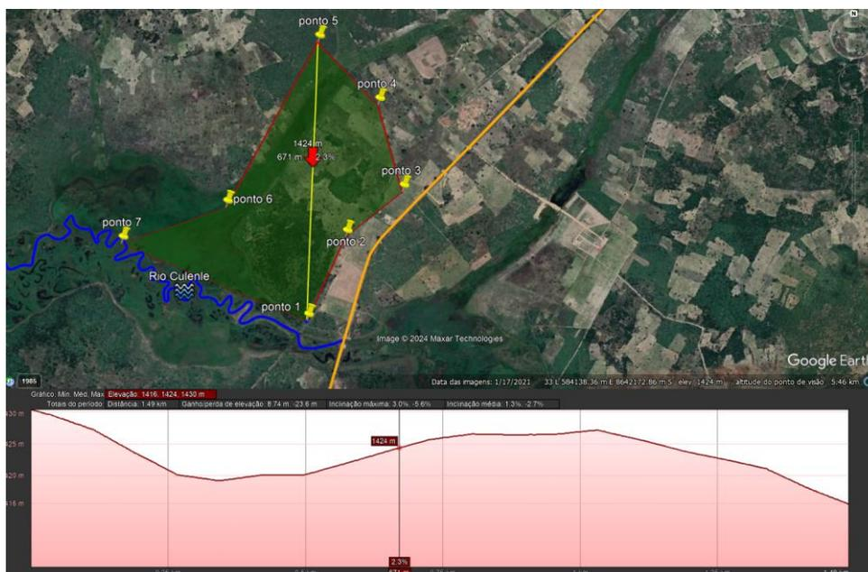
Figura 3: Pantanal do Bailundo, LDA, com a elevação máxima de 1430 e média de 1424m sentido Norte e Sul. Inclinação máxima de 3.0% e a média de 1.3% com uma distância de 1.49 km
