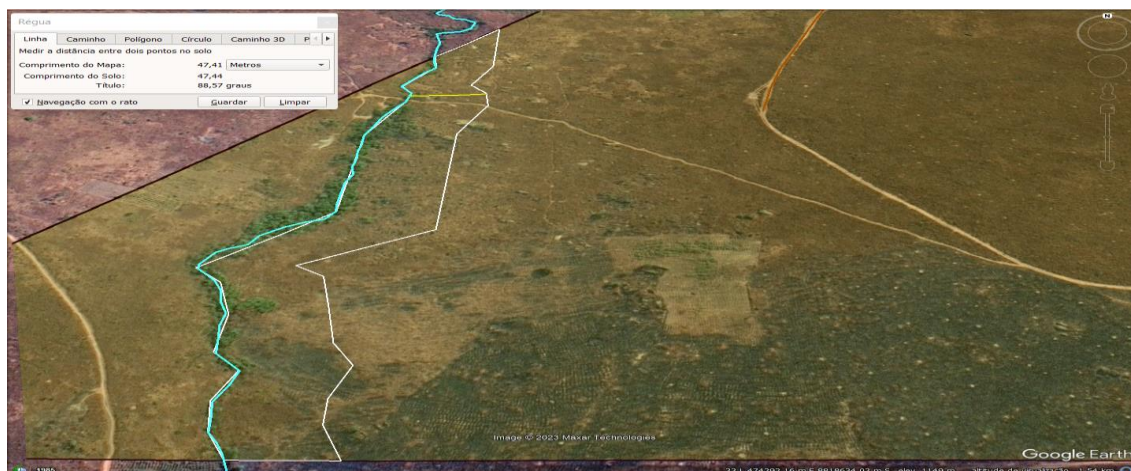
Figura 7: Limites em branco demarcando a área reservada para a protecção da fonte de água contra contaminações, cerca de 3,4 hectares.
