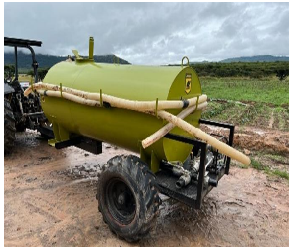
Figura 13: Cisterna para transporte de água
