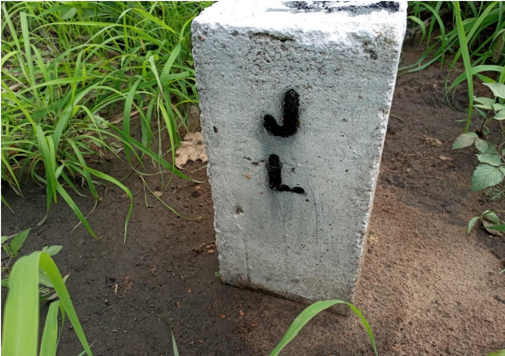
Figura 14: Marco Geodésico dentro da fazenda
