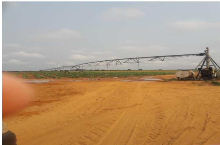
Figura 4: Pivot capacidade de rega para 55 ha
