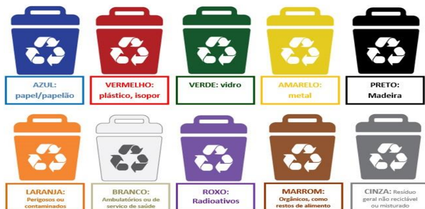
Figura 9: Segregação de resíduos
