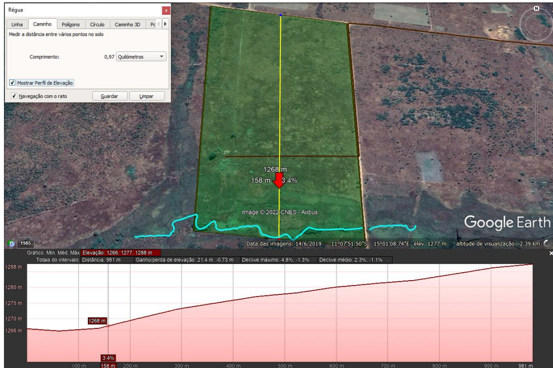
Figura 3: Mapa de elevação no sentido latitudinal norte-sul, há uma diferença de cota entre os 1266 e 1288 m de 21,4 m distribuídos em uma distância de 981 m, com inclinação máxima de 4,8 % e média de 2,3%. Medidas anti erosivas são dispensáveis.
