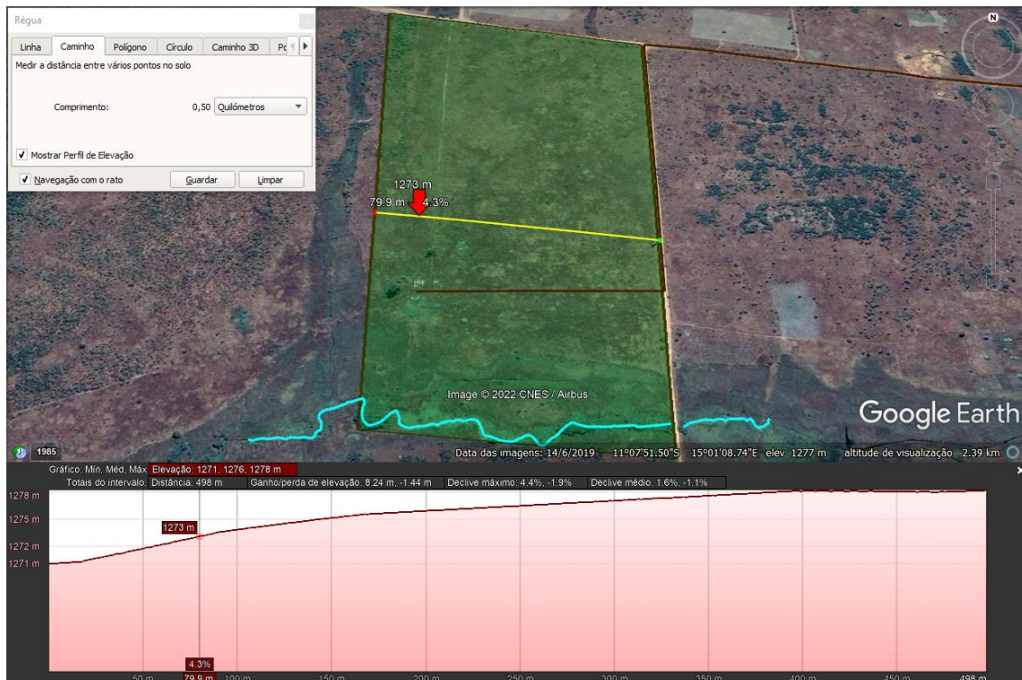
Figura 4: Mapa de elevação no sentido latitudinal norte-sul, há uma diferença de cota de 8,24 m entre os 1271 e 1278 m distribuídos em uma distância de 498 m, com inclinação máxima de 4,4 % e média de 1,6%. Dispensa-se assim a necessidade de implementação de medidas anti erosivas.
