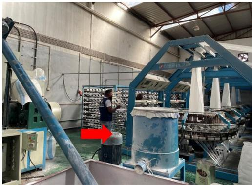
Figura 5: Abastecimento da matéria-prima ( Polipropileno)
