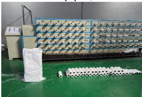
Figura 7: Máquina de bobinagem de fio fino
