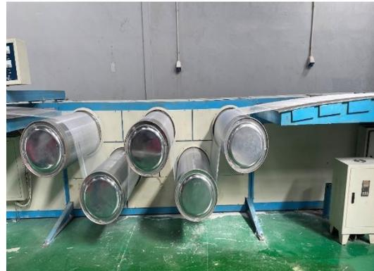
Figura 6: Máquina de tecido que faz o corte das linhas
