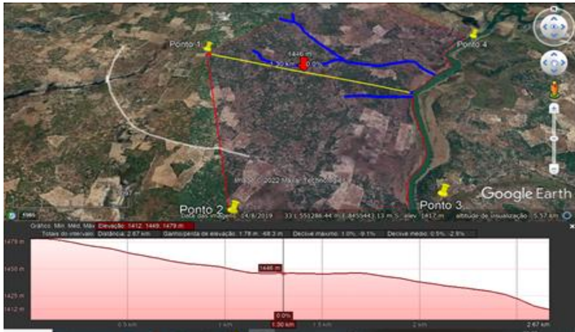
Figura 7: Numa distância de 2,67 km, entre o ponto 1 e a exterminada este da fazenda, cujo limite é o rio Cunene há, numa altitude cujo o ponto mais alto é de 1479 m e o mais baixo de 1414 m, numa diferença de elevação de 1,75 m (- 67,6 m) com uma inclinação máxima.
