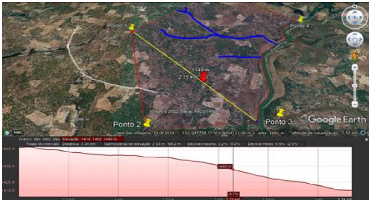
Figura 6: Numa distância de 3,37 km, entre o ponto 1 e 3, há uma diferença de altitude cujo ponto mais alto é de 1479 e o mais baixo de 1413 m, numa diferença de elevação de 2,52 m (- 66 m) com uma inclinação máxima de 37% (- 5.4%) e média de 0,7% (- 2.3%). Área.
